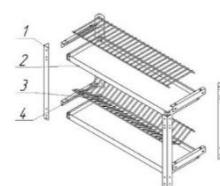
3. Прикрепить кронштейны сушки (поз. 4) к опорам (поз. 1) при помощи болтов, гаек и шайб;
