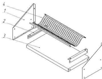
1. К полке (поз. 3) при помощи болта М6х12, гайки М6 и шайбы М6 прикрепить боковые стенки (поз. 1);
