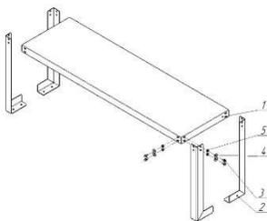
1. Установить полку (поз. 1) на стойках (наживить). Закрепить болтовыми соединениями (болт М6х12 (поз. 3), гайка М6 (поз. 4) и шайба М6 (поз. 5)).
