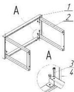
1. Прикрепить полку (поз. 1) к опорам (поз. 2) как указано на схеме сборки. Закрепить при помощи винтов М6\*35 (поз. 3) и болтов М6\*15 (поз. 4);
