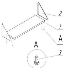
1. К полке (поз. 1) при помощи винтов (поз. 3) прикрепить боковые стенки (поз. 2);
