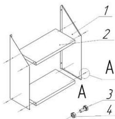
1. К полке (поз. 2) при помощи болта М6х12 (поз. 3) и гайки М6 (поз. 4) прикрепить боковые стенки (поз. 1);
