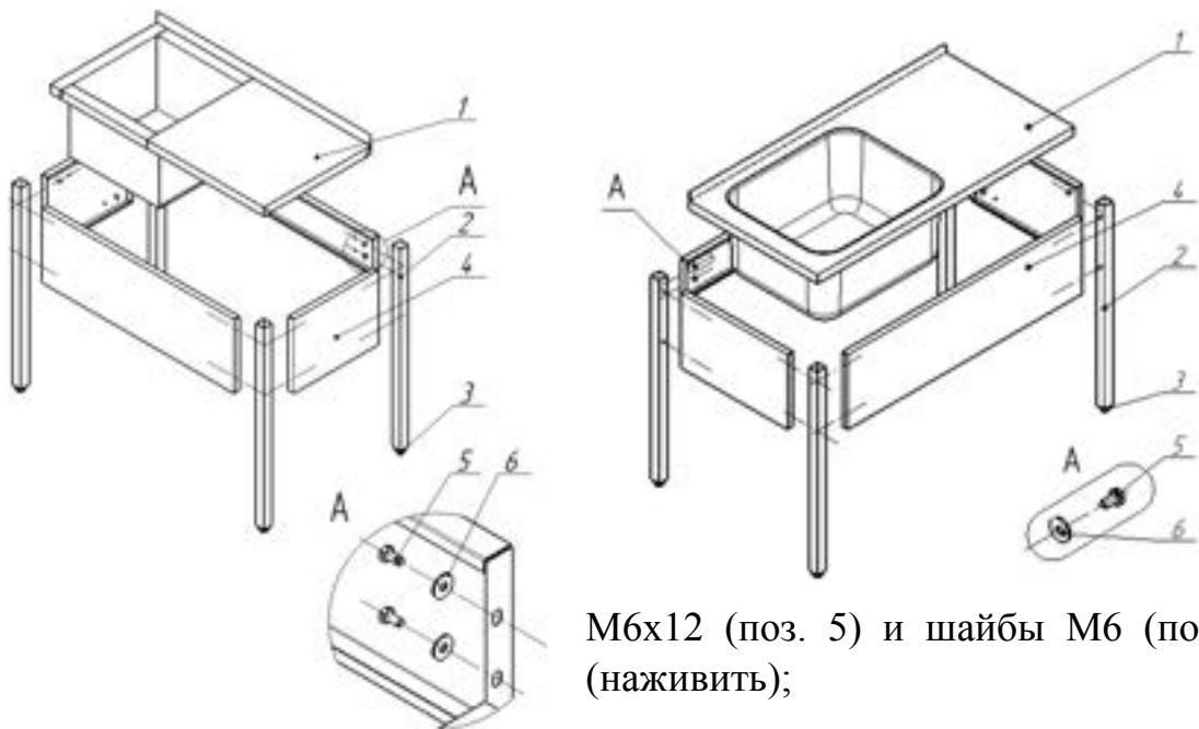
M6x12 (поз. 5) и шайбы M6 (поз. 6)
