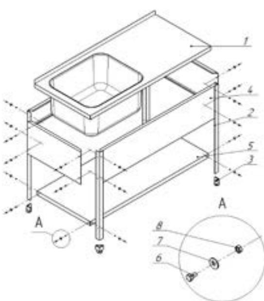
сборе на предусмотренное место и регулировочными опорами установить горизонтальное положение ванны.
